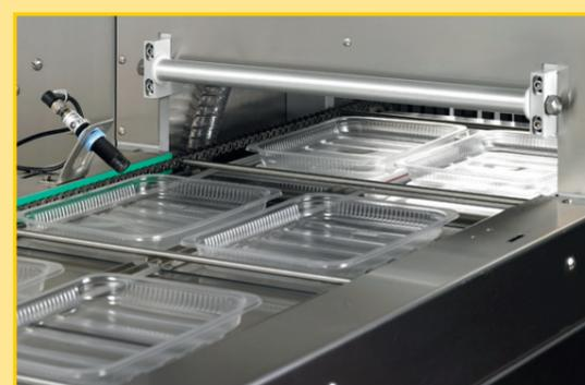
Termoselladoras automática al vacío (o sin), para envases preformados. Envasado al vacío con atmósfera modificada o con vacío y efecto skin, para conseguir una mayor conservación, una mejor presentación, así como facilidad de almacenaje y transporte.
